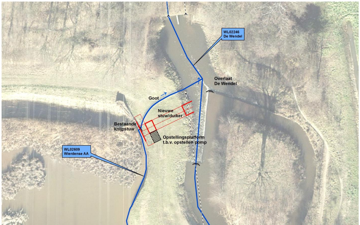
Figuur 13. Calamiteiten opstellingsplatform aflaatstuw Wendel . Opstellingsplatform aan de noordzijde
