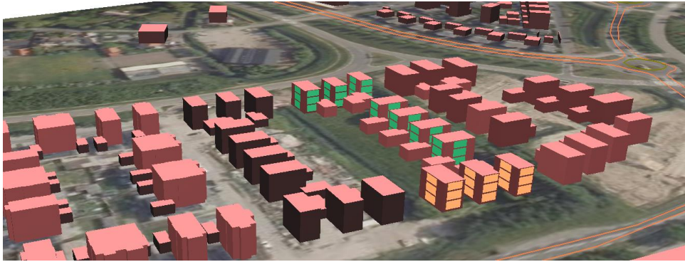
Figuur 8: Geluidbelasting in Letm vanwege Burgemeester Middelweerdbaan (incl. 5 dB aftrek cf art 110g Wgh) gezien vanaf zuidwesten.
