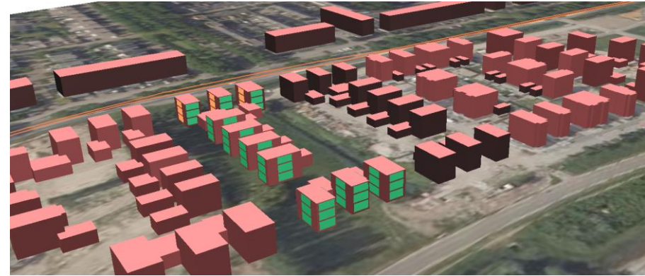
Figuur 10: Geluidbelasting in Letm vanwege Burgemeester Middelweerdbaan (incl. 5 dB aftrek cf art 110g Wgh) gezien vanaf noordoosten.
