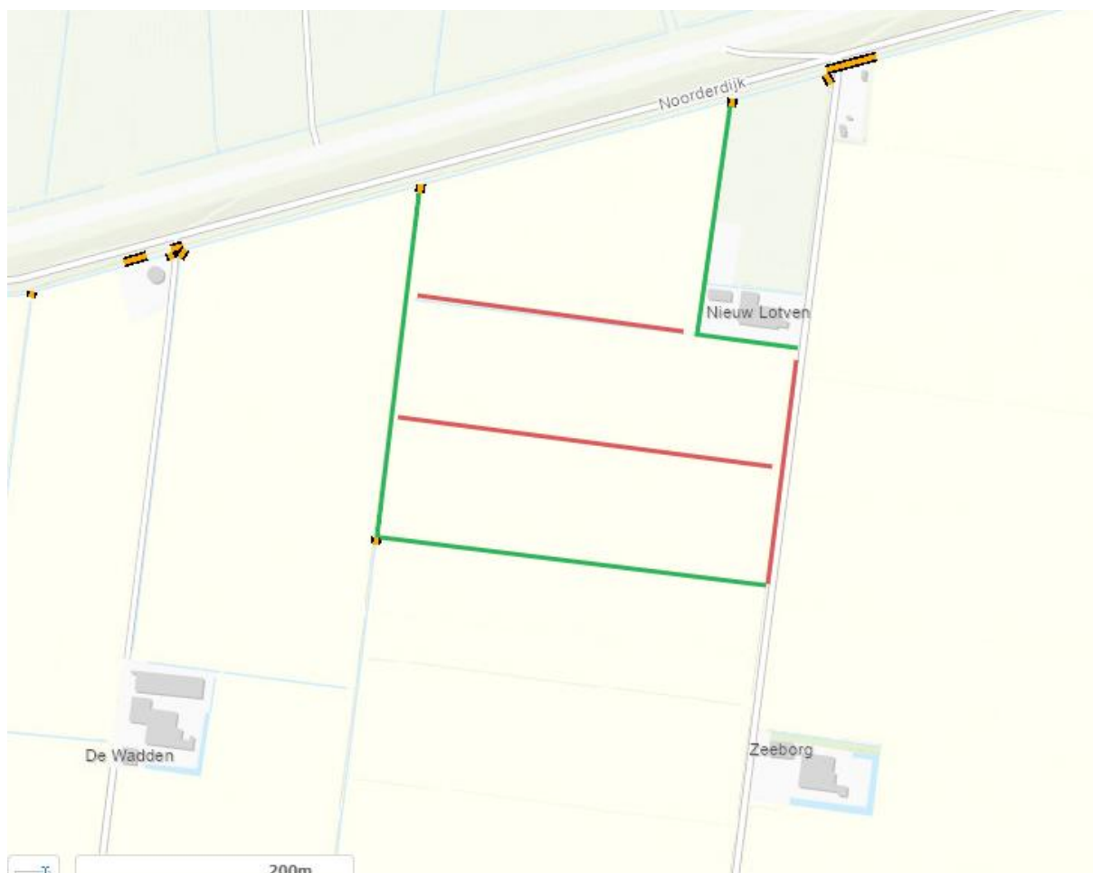
Figuur 1: Locatie van werkzaamheden. De rode lijnen geven te dempen watergangen weer. De groene lijnen geven de te verbreden watergangen weer.
