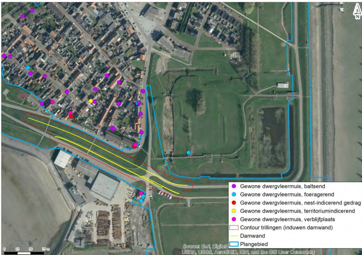
Afbeelding 4.10 Contour van trillingen door het induwen van damwanden
