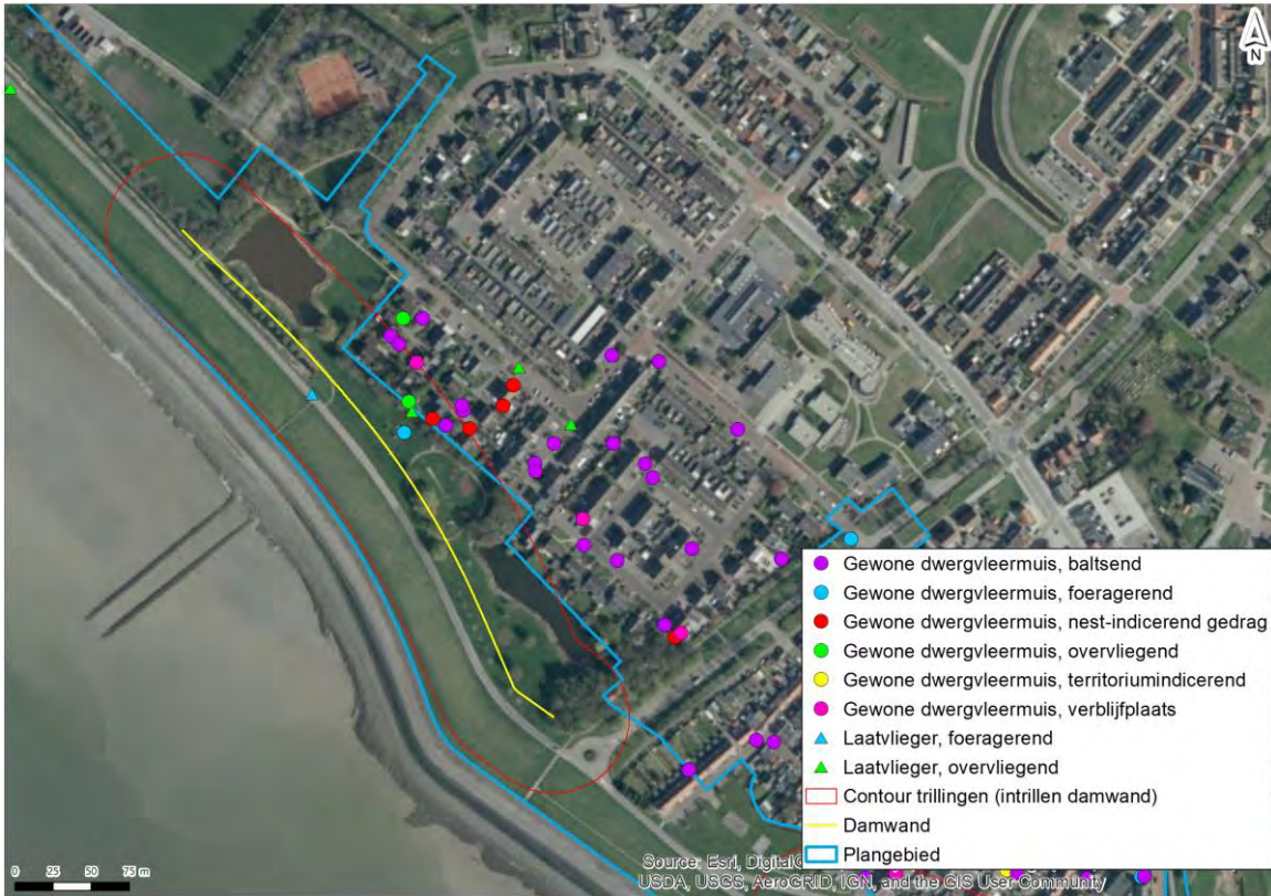
Afbeelding 4.9 Contour van trillingen door het intrillen van een damwand
