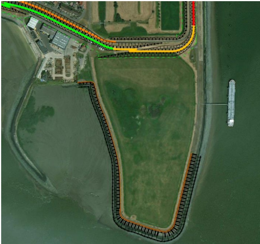
Afbeelding 3.7 Bovenaanzicht Slibdepot (in kleur is indicatie weergegeven: rood dijksectie Kanaalzone, geel dijksectie Slibdepot, groen dijksectie Dorpsrand Werfdijk, oranje damwand binnenteen)
