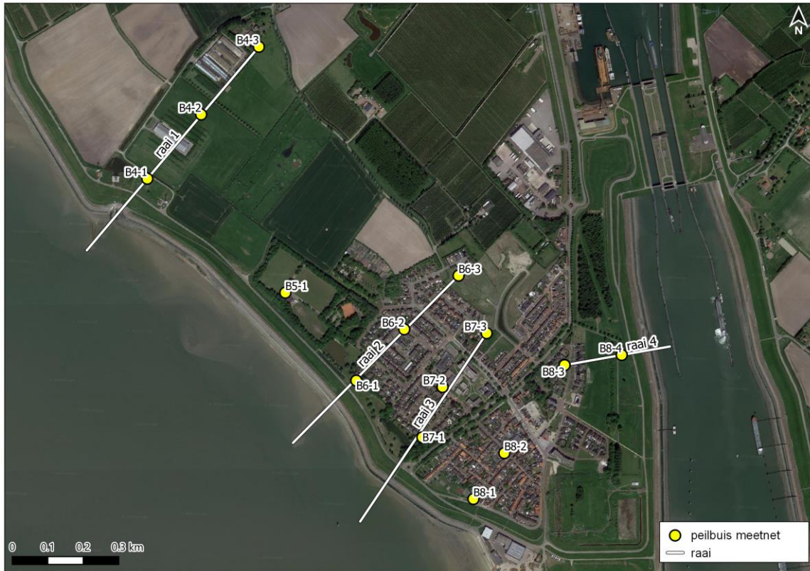
Afbeelding 4.5 Overzicht meetraaien en peilbuizen Hansweert
