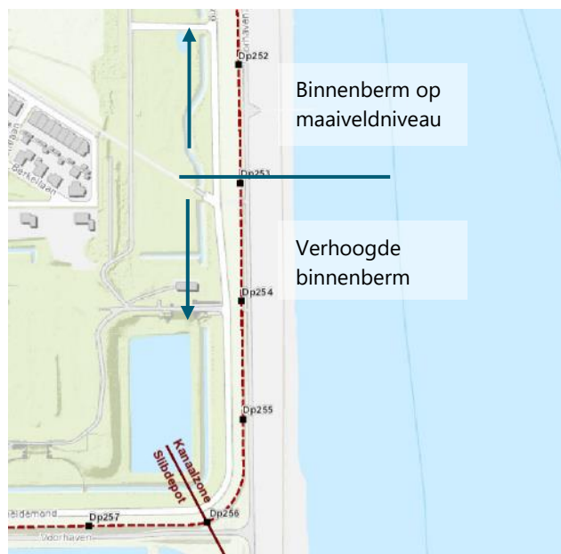
Afbeelding 3.3 Overgang verhoogde berm naar berm op maaiveld
