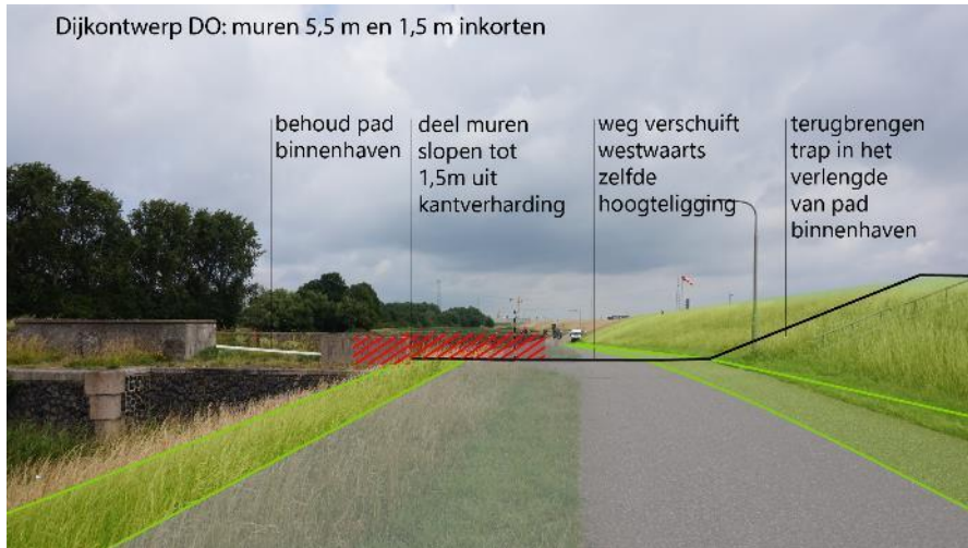
Afbeelding 3.5 Gekozen inpassing sluishoofd waarbij muren worden
