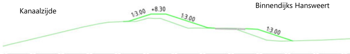
Afbeelding 3.5 Dwarsprofiel Kanaalzone - verhoogde binnenberm - dp253-dp256
