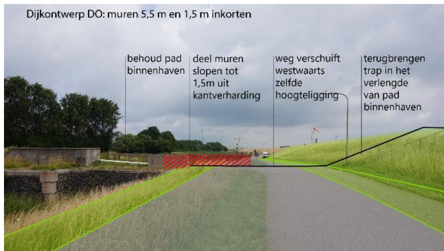
Afbeelding 2.12 Gekozen inpassing sluishoofd waarbij muren worden
