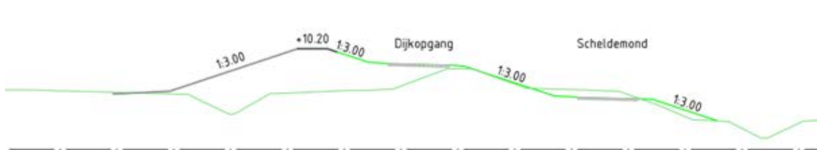
Afbeelding 2.15 Dwarsprofiel Slibdepot, met buitendijks de Voorhaven en binnendijks de Scheldemonde
