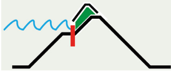
Afbeelding 3.7 Schema constructieve oplossing + grondophoging buitendijks
