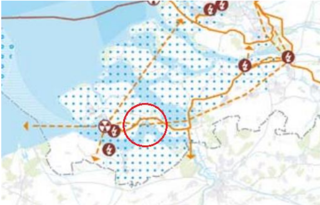
Afbeelding 5.11 Kaart ruimte voor energievoorziening met indicatief tracé nieuwe hoogspanningsverbinding
