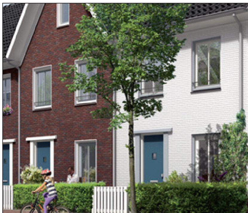
Detailtering ramen. Kenmerkende verticaliteit. Variatie in borstwering, neggemaat en kozijnaanzicht.
