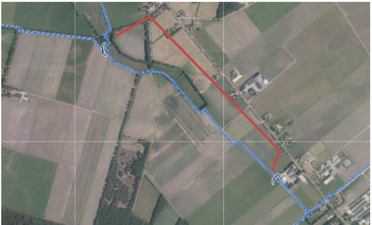
Figuur 1. Traject waarover de peilverhoging in de zomer plaats vindt om zo het aangevoerde water beter vast te houden.
