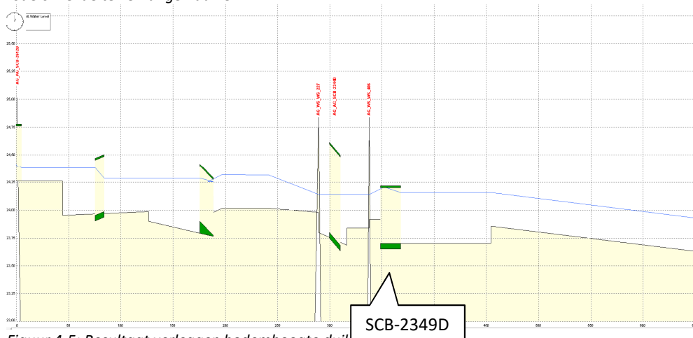
Figuur 4-5: Resultaat verleggen bodemhoogte duiker (0,5 MA)
