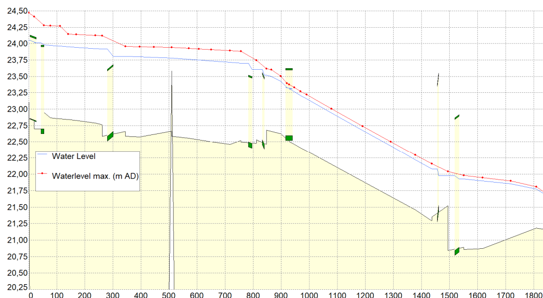
Figuur 11-7: Lengteprofiel van de T25-winterscenario's met in het rood de T25 huidige situatie, exclusief klimaattoeslag. In het blauw de T25 definitief ontwerpsituatie, inclusief klimaattoeslag.
