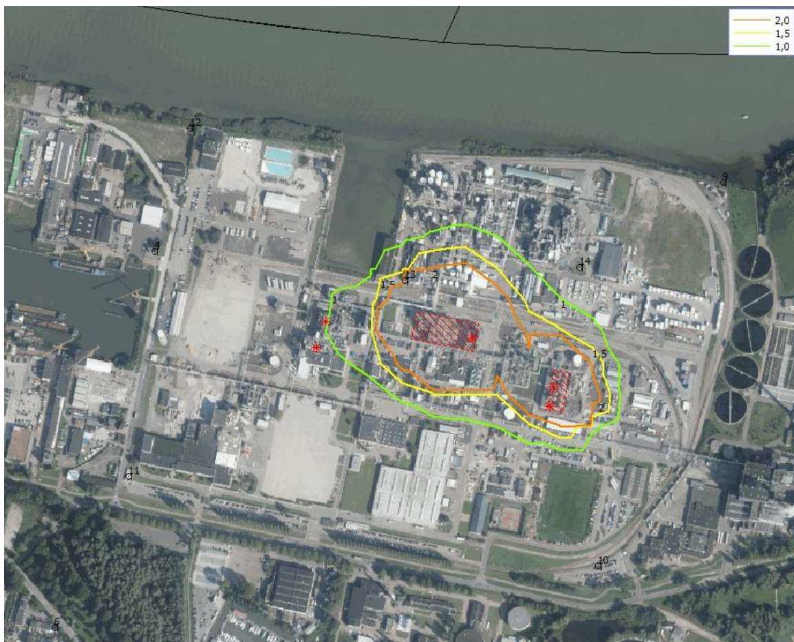
Afbeelding 5.2 Immissiecontouren van formaldehyde, gebaseerd op een reguliere emissie van ongeveer 3.000 kg/jaar in \mu\text{g}/\text{m}^3
