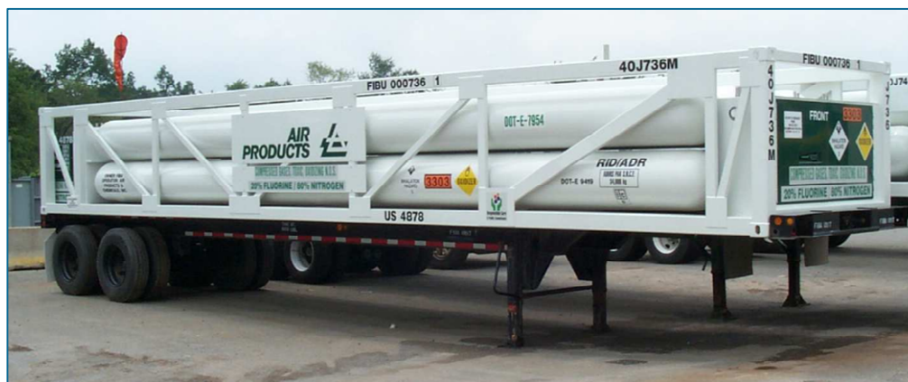
Figuur 1: trailer met 8 tubes
