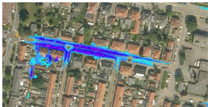
Berekend water-op-straat Generaal Pironstraat (masterplan riolering, Arcadis)
