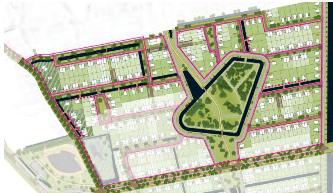
voorstel positie ondergrondse kabel- en leidingenzones
