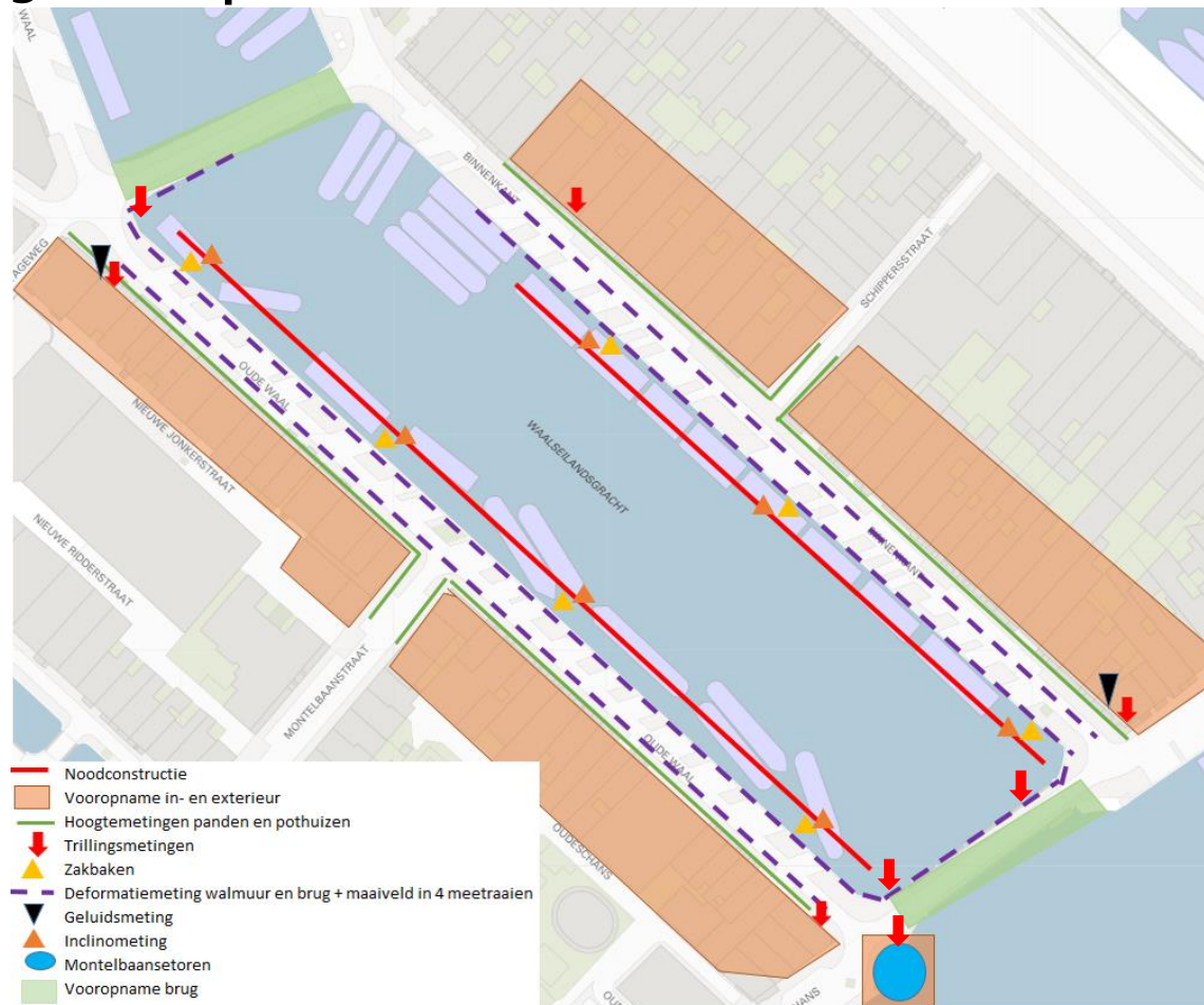
Figuur 1: Schetsmatige meetopzet monitoring omgeving Waaleilandsegracht WEG0201 0202
