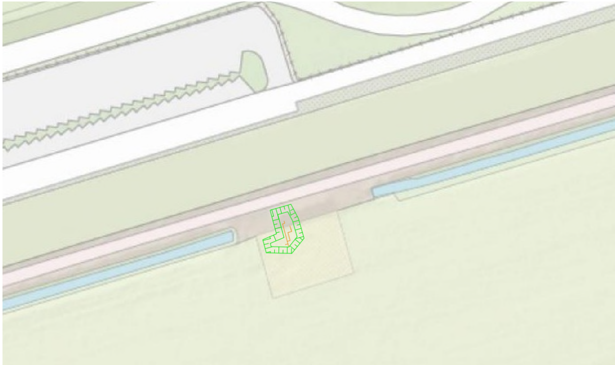
Figuur 2: geplande ontgraving, ontgravingsdiepte 2,5 m-mv (bron: opentopo).
