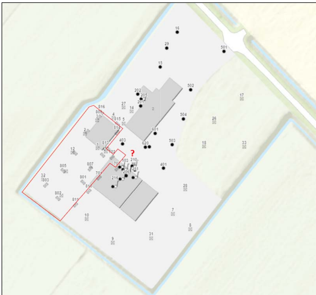
Figuur 4.2 Contour gewogen asbest boven de interventiewaarden
