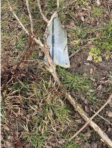
Foto 13: Asbest op maaiveld
