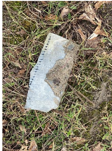
Foto 11: asbest op maaiveld saneringslocatie (2)
