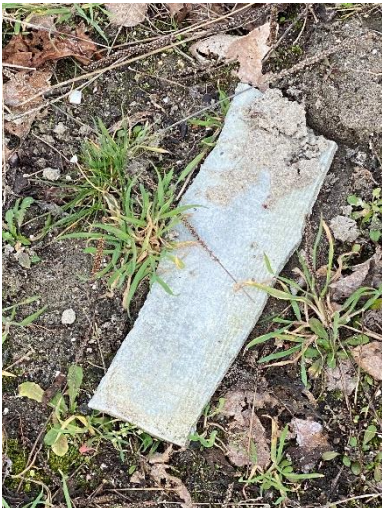
Foto 10: Asbest op maaiveld (3)
