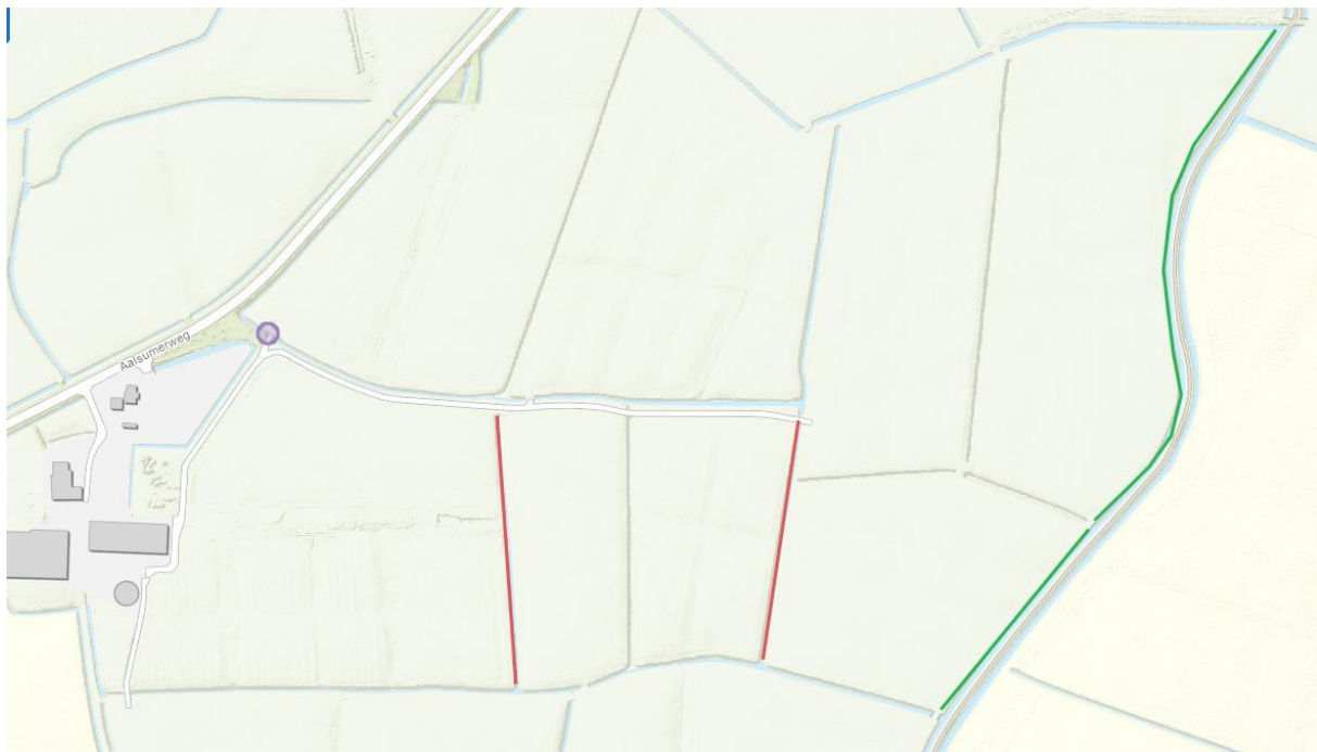
Figuur 1: Locatie van werkzaamheden. De rode lijnen geven te dempen watergangen weer. De groene lijn geeft de te verbreden watergang weer. De paarse cirkel geeft de te verlengen dam met duiker weer.
