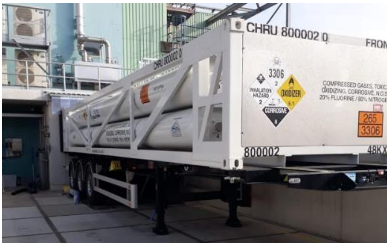
Figuur 2 – MEGC t.b.v. de aanvoer van fluor/stikstofmengsel.
