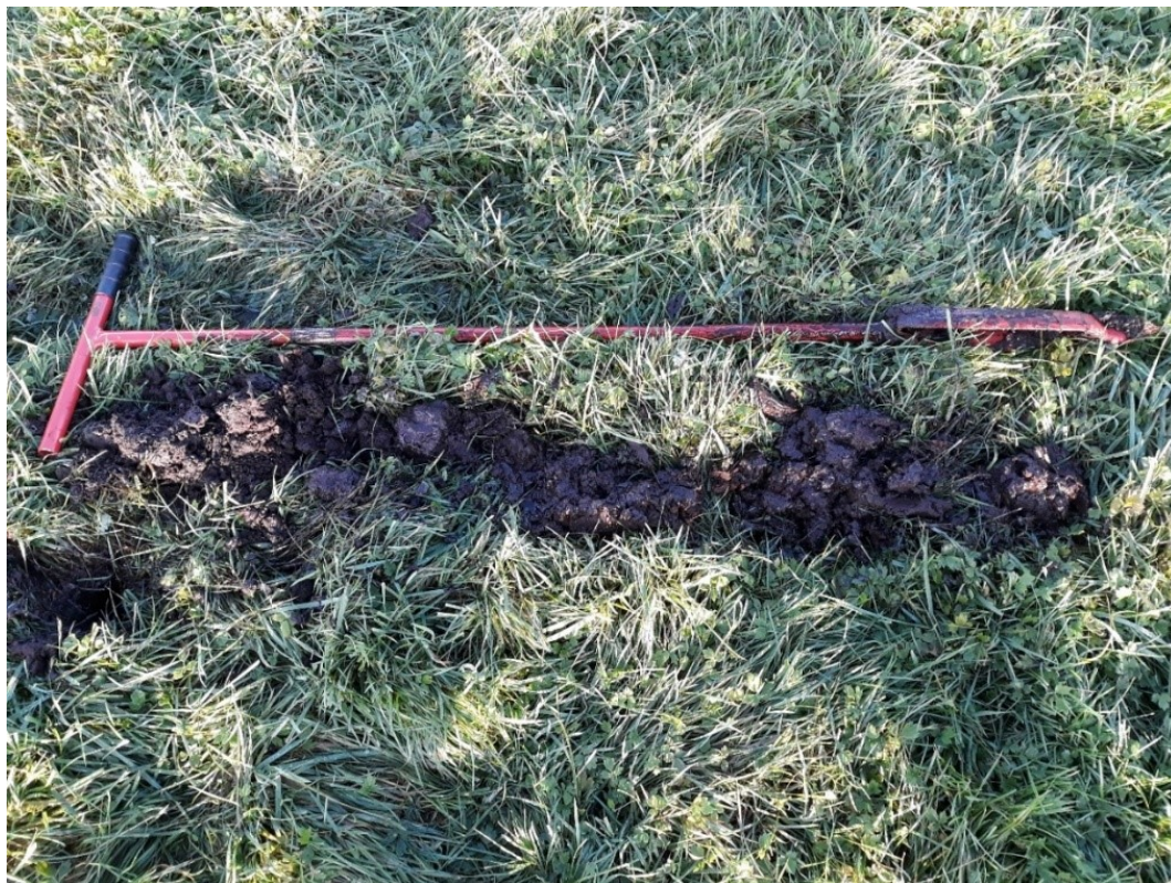
Afbeelding 2.7 Foto grondboring. De bovenste laag bevindt zich bij het heft van de boor.
