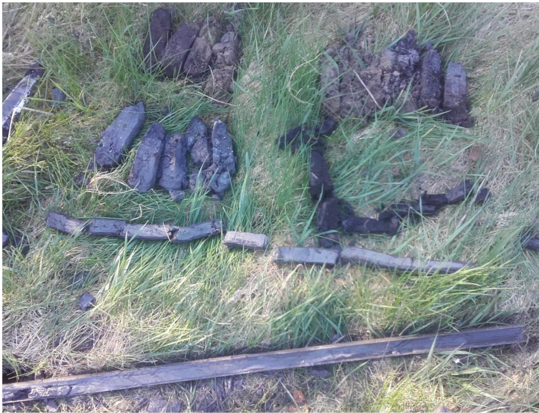
Afbeelding 3 Boormonsters van boring 4110002; Tot een diepte van 150 centimeter beneden maaiveld is een verstoorde laag bestaande uit vooral bouwzand aanwezig. Daaronder is tot een diepte van 190 centimeter beneden maaiveld verstoord veen aangetroffen. Onder het veen is slappe klei aangetroffen tot een diepte van 4 meter beneden maaiveld. Bron: foto Vestigia d.d. 10 april 2019.
