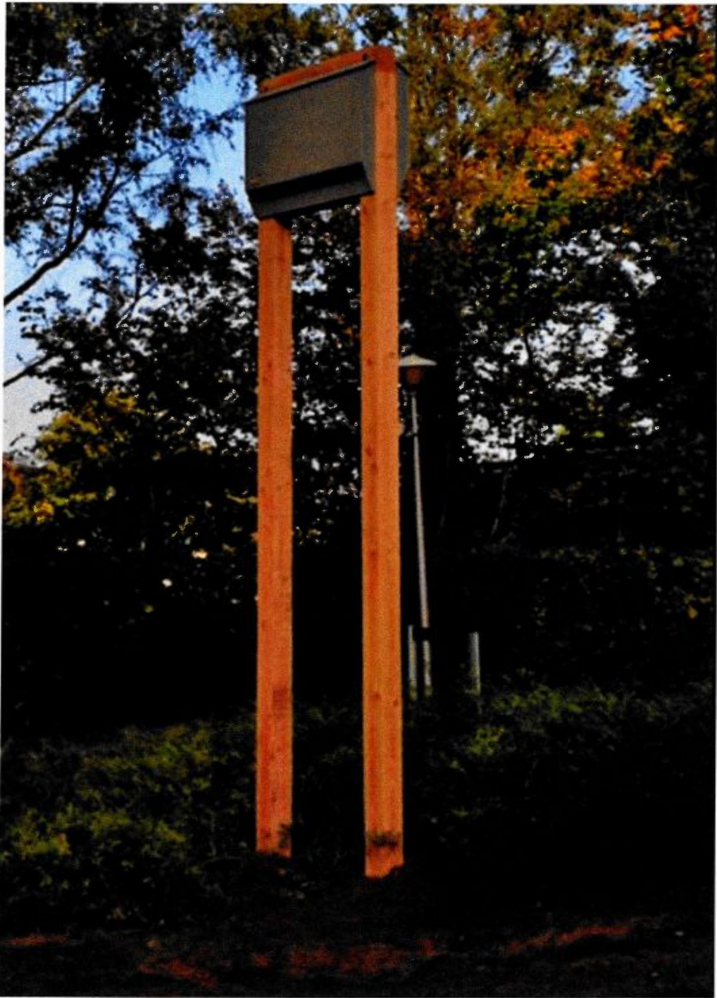
Afbeelding 12. Dubbele grote vleermuiskast op 2 dikke Douglas-palen
