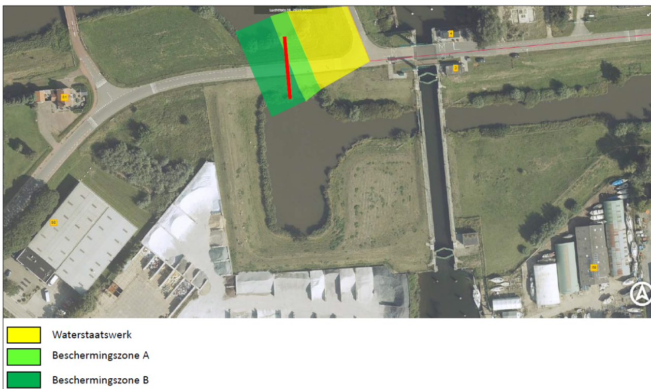
Figuur 2.4: Ligging duiker ten opzichte van zonering primaire waterkering
