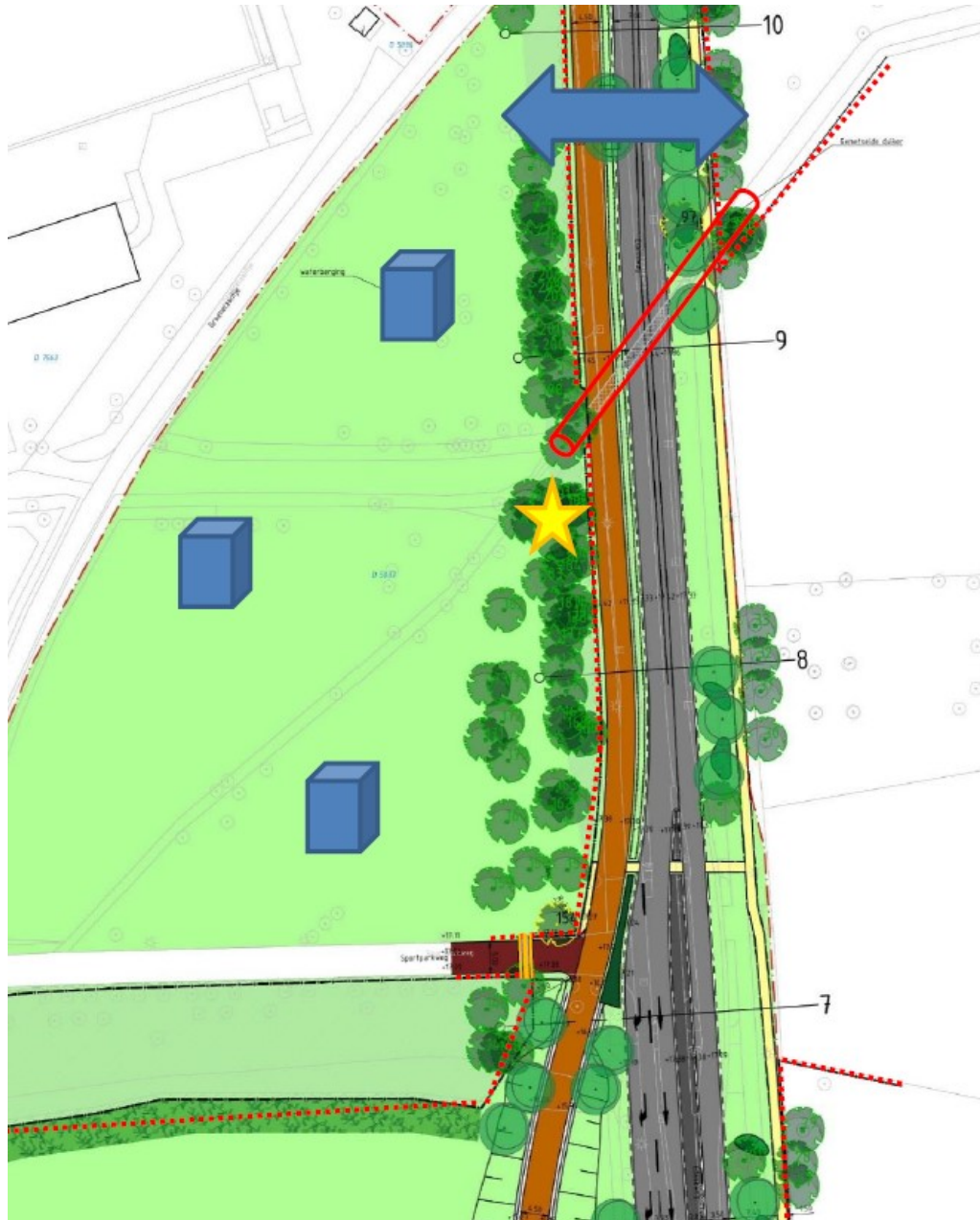
Figuur 4 Maatregelen ter hoogte van Edeseweg en Groene Laantje. Met dassenraster (rode stippellijn) dassentunnel (rode lijn) wildrooster (geel) en locatie boombrug (blauwe pijl) en eekhoornkasten (blauwe blokken), gele ster is bestaand eekhoornnest.
