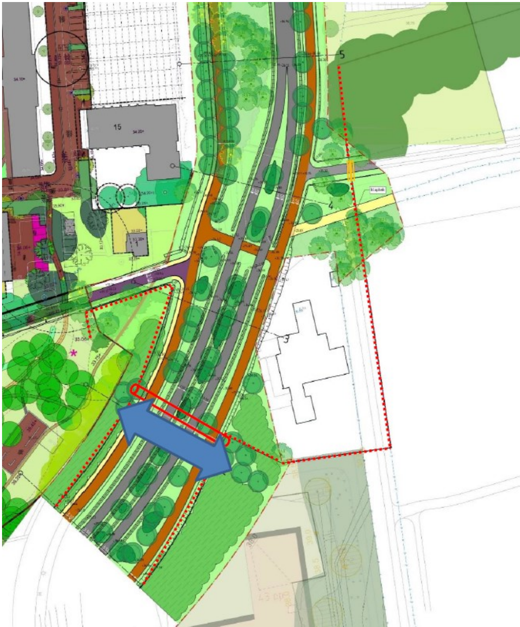
Figuur 3 Kruispunt Kazernelaan-Parklaan nabij bosgebied De Sysseelt. Met dassenraster (rode stippellijn) dassentunnel (rode lijn) wildrooster (geel) en locatie boombrug (blauwe pijl).
