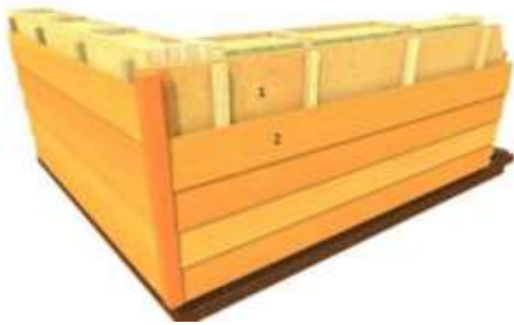
Figuur 5 – Schematische tekening van HSB muur met gevelbekleding
