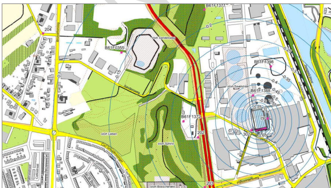
Figuur 4 Voorgestelde monitoringspeilbuizen en de verlagingcontouren (GHG-situatie)
