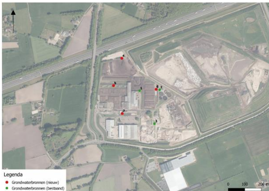
Figuur 1.1: Bestaande en geplande grondwaterbronnen ter plaatse van de projectlocatie
