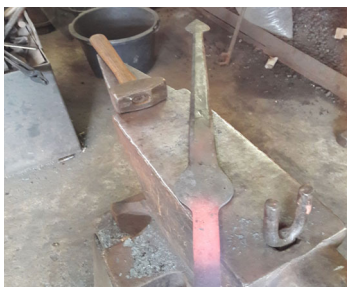
Deurhengsel replica door smid
