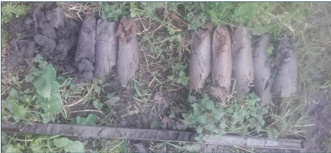
Afbeelding 3 De boorkernen van boring 3876003. Kenmerkend voor deze boring is de aanwezigheid van veraard veen onder de huidige laagste grondwaterstand. Bron: foto Vestigia d.d. 17-02-2020.
