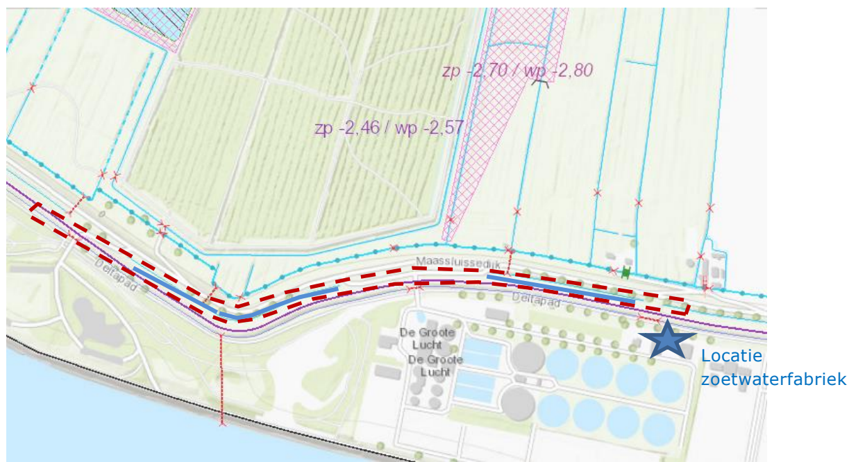
Figuur 1, de wegsloten waarlangs het water van de zoetwaterfabriek gaat afstromen
