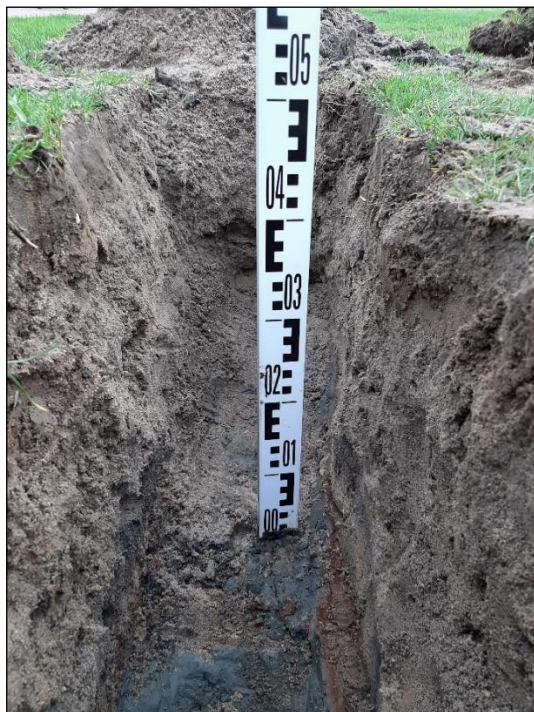
Figuur 15. Proefsleuf nabij boom 3 op 1,5 meter uit het hart van de stam. Geen beworteling aangetroffen.
