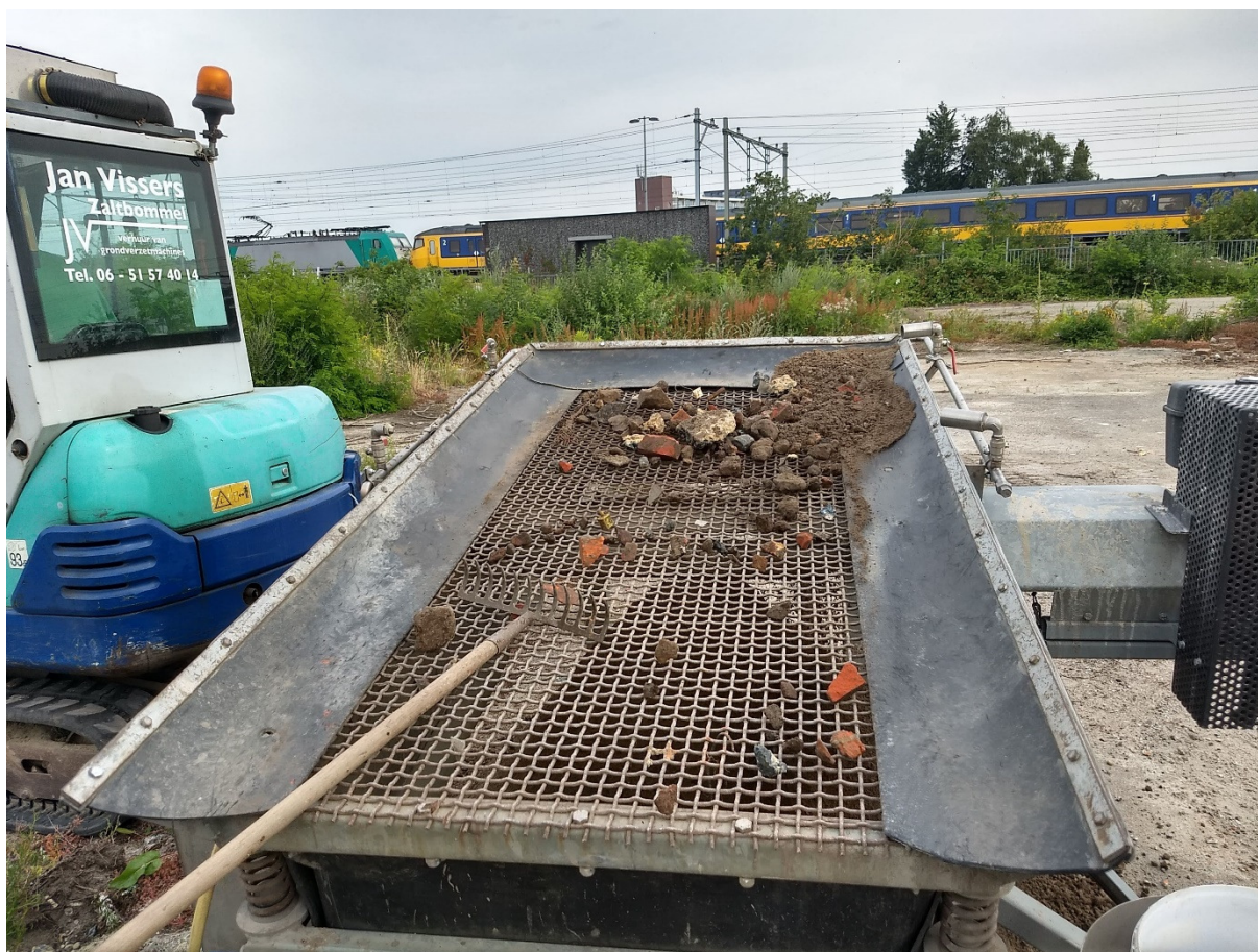
Foto met de gebruikte machinale zeef (2cm) op de onderzoekslocatie.
