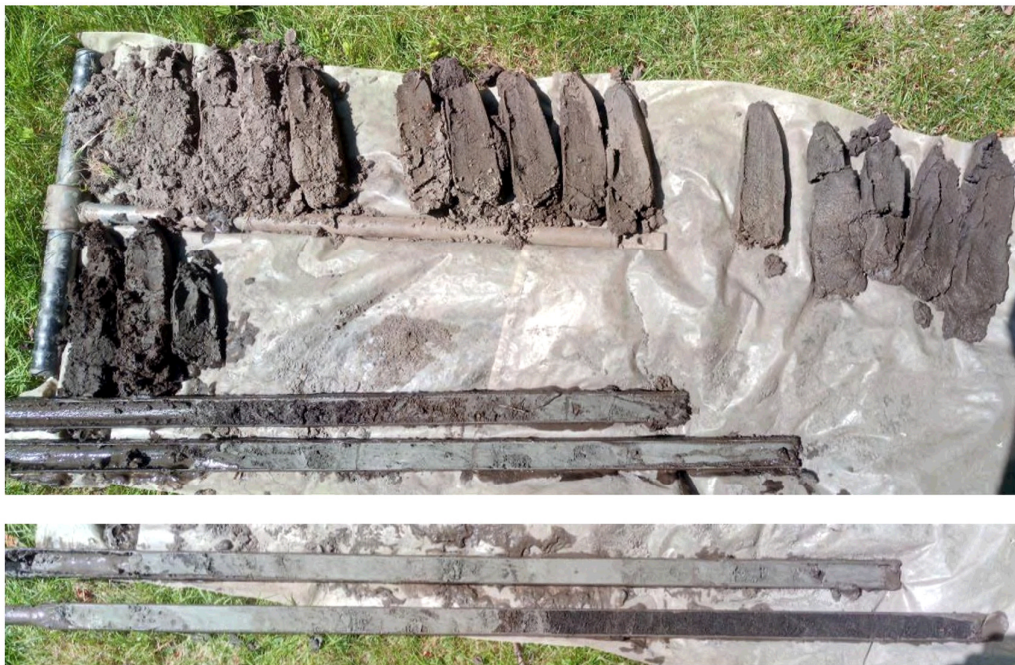
Boring 7. Boven: 0-250 cm -Mv. Onder: 250-400 cm -Mv. Op deze foto's is zowel het donkergekleurde duinzand als de kleiige, grijze vulling van het kanaal van Corbulo goed te zien.
