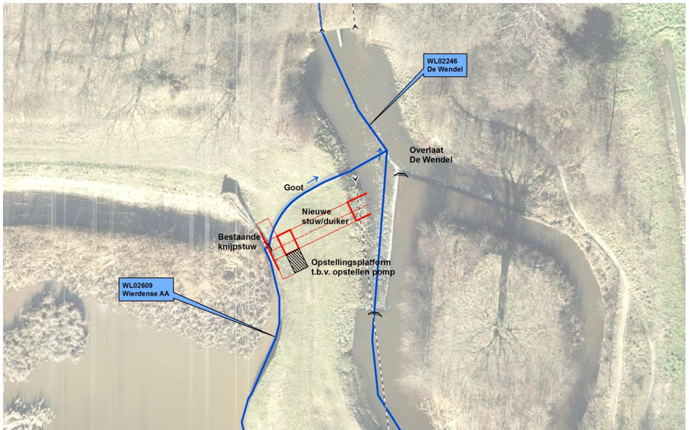
Figuur 13. Calamiteiten opstellingsplatform aflatstuw Wendel . Opstellingsplatform aan de noordzijde
