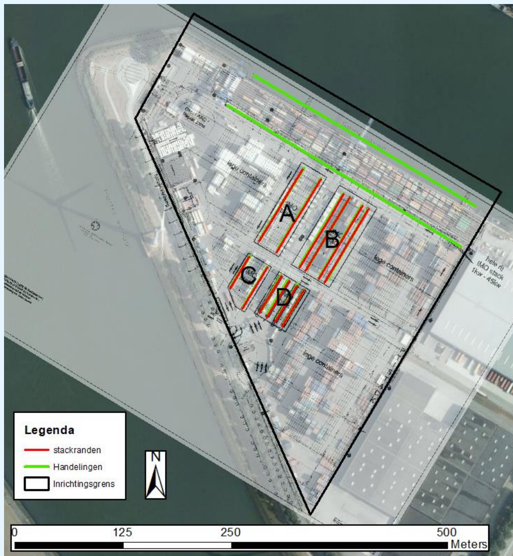
figuur 5: overzicht gemodelleerde ongevalslocaties. Op de met groen aangegeven locaties vinden handelingen plaats, op de met rood over groen aangegeven stacklocaties vinden ook handelingen plaats, maar zijn ook intrinsiek falen en een BLEVE gemodelleerd.
