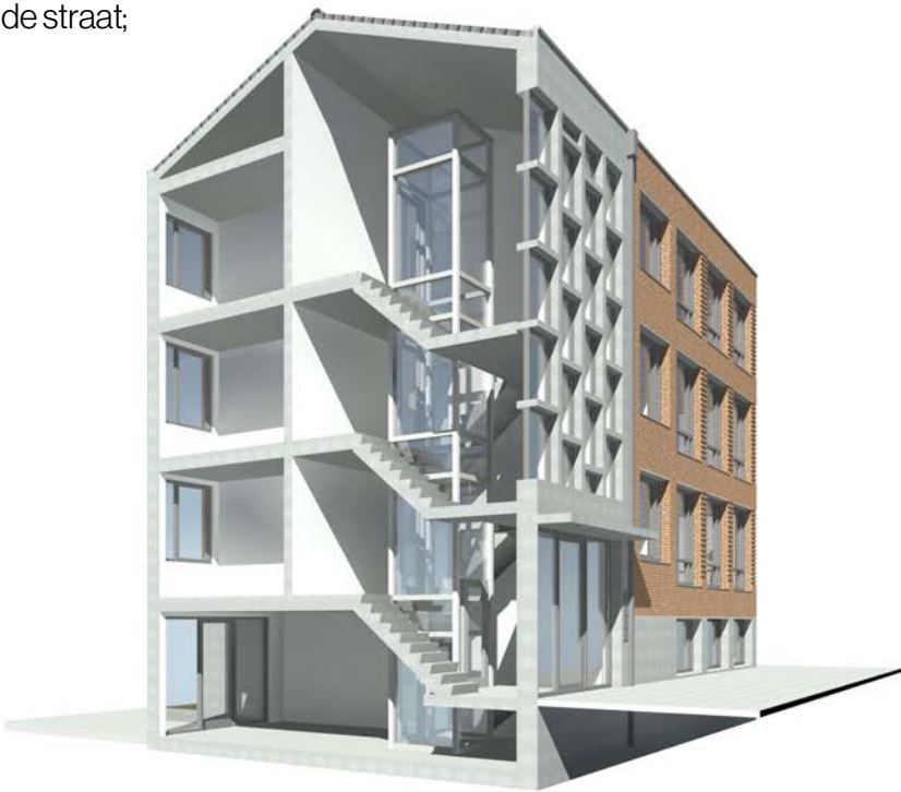
Doorsnede over portiek
