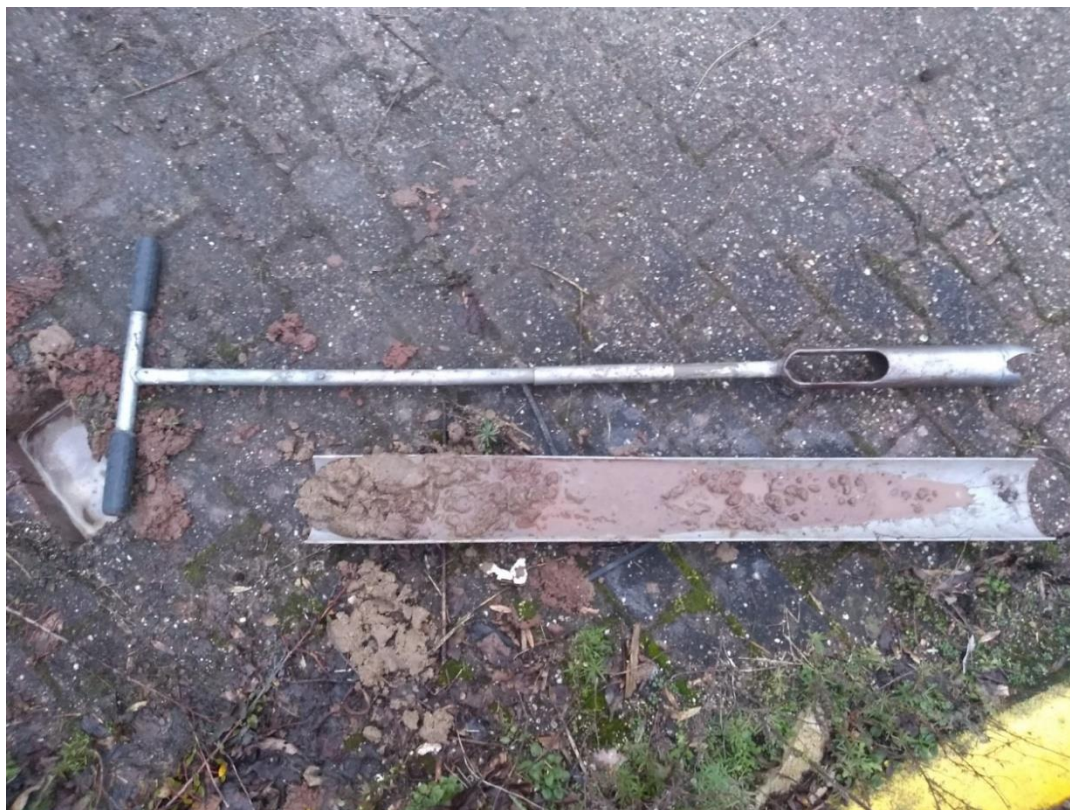
Afbeelding 15: Foto van de boorkern van boring 2. Door de combinatie van menggranulaat en de hoge grondwaterstand was het ter plaatse van boring 1 en boring 2 niet mogelijk om dieper te boren dan 1 m-mv.
