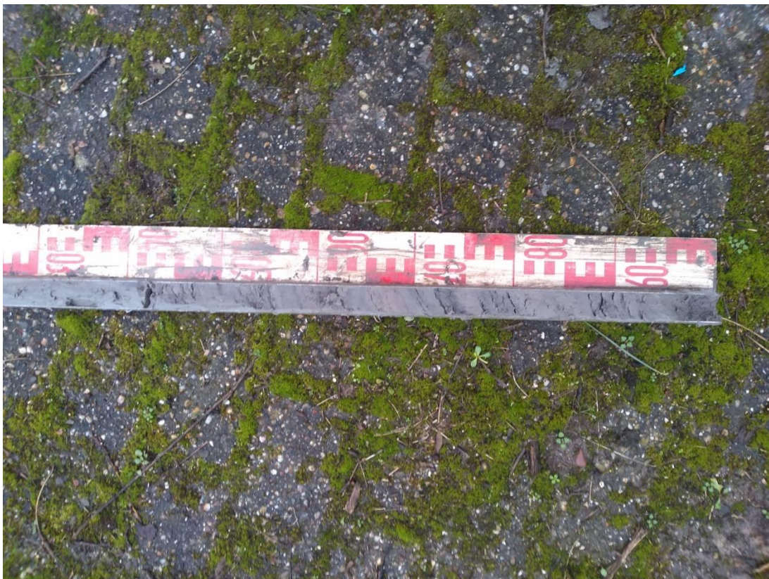
Afbeelding 16: Foto van de basis van de boorkern van boring 5 met duidelijk zichtbaar de afwisseling van bandjes bruingrijze ongerijpte kalkloze klei en bandjes kleilig fijn zand met fijn schelpgruis (getijafzettingen).
