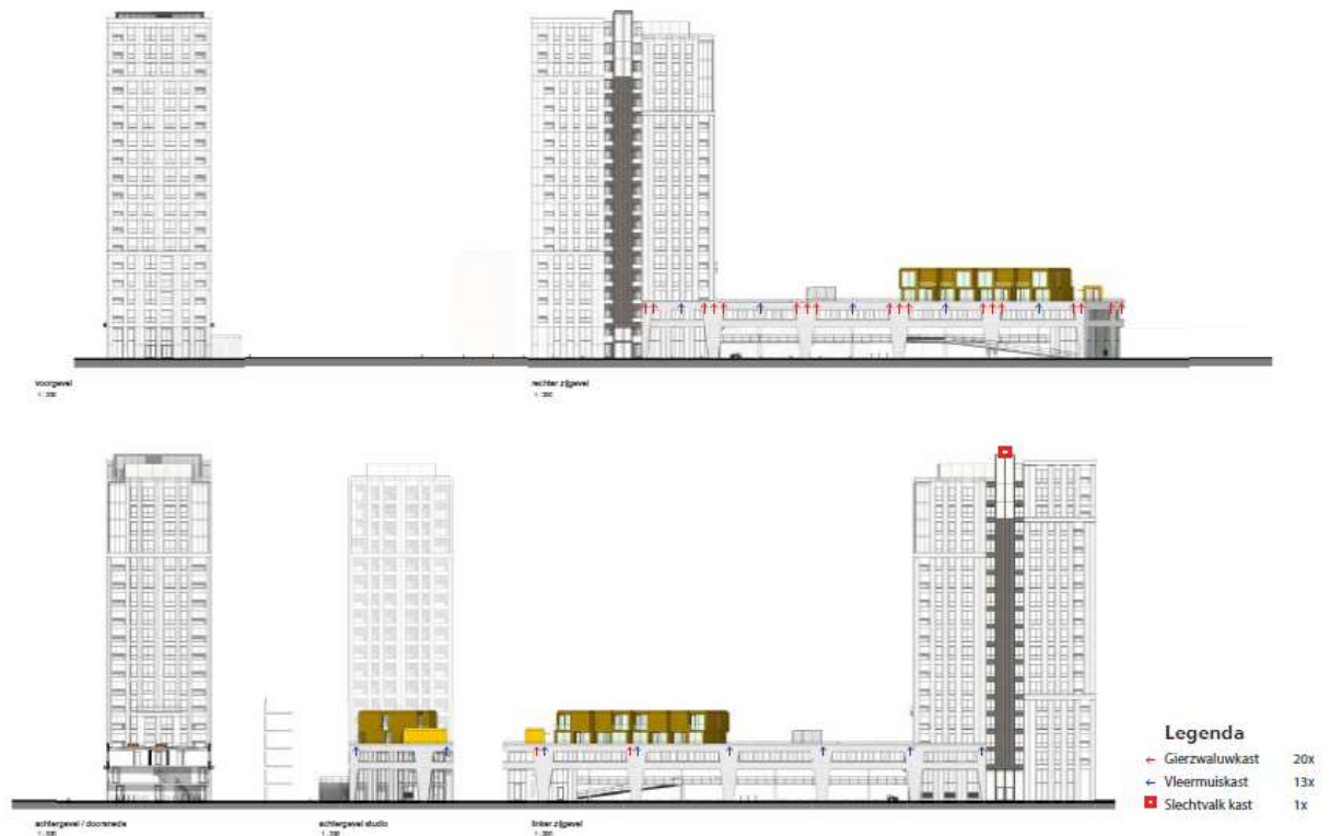
Figuur 4: Locaties permanente inbouwkasten voor vleermuizen (blauw) en bovenwettelijke inbouwkasten voor gierzwaluw en slechtvalk
