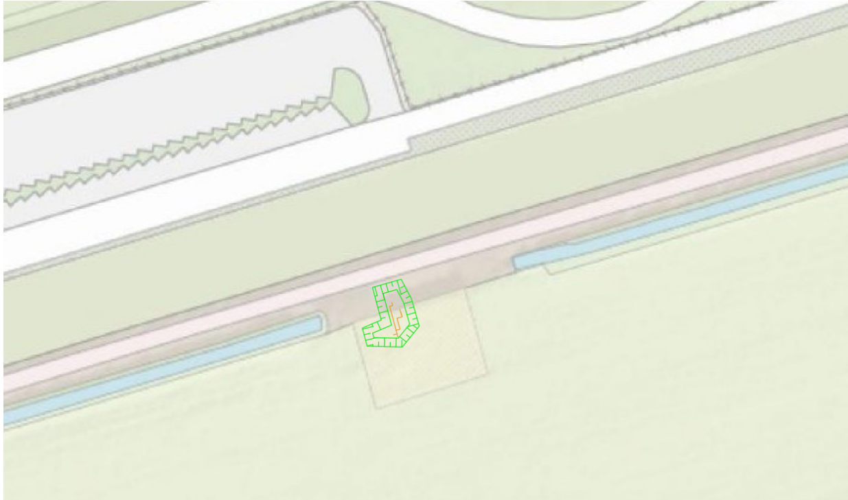
Figuur 2: geplande ontgraving, ontgravingsdiepte 2,5 m-mv (bron: opentopo).
