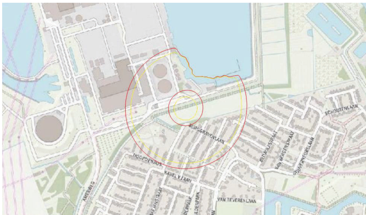
Figuur 4: Theoretisch invloedsgebied (verlagingscontour 0,05 meter en 0,5 meter) bij bemaling onder GHG (rode lijnen) en GLG (gele lijnen)
