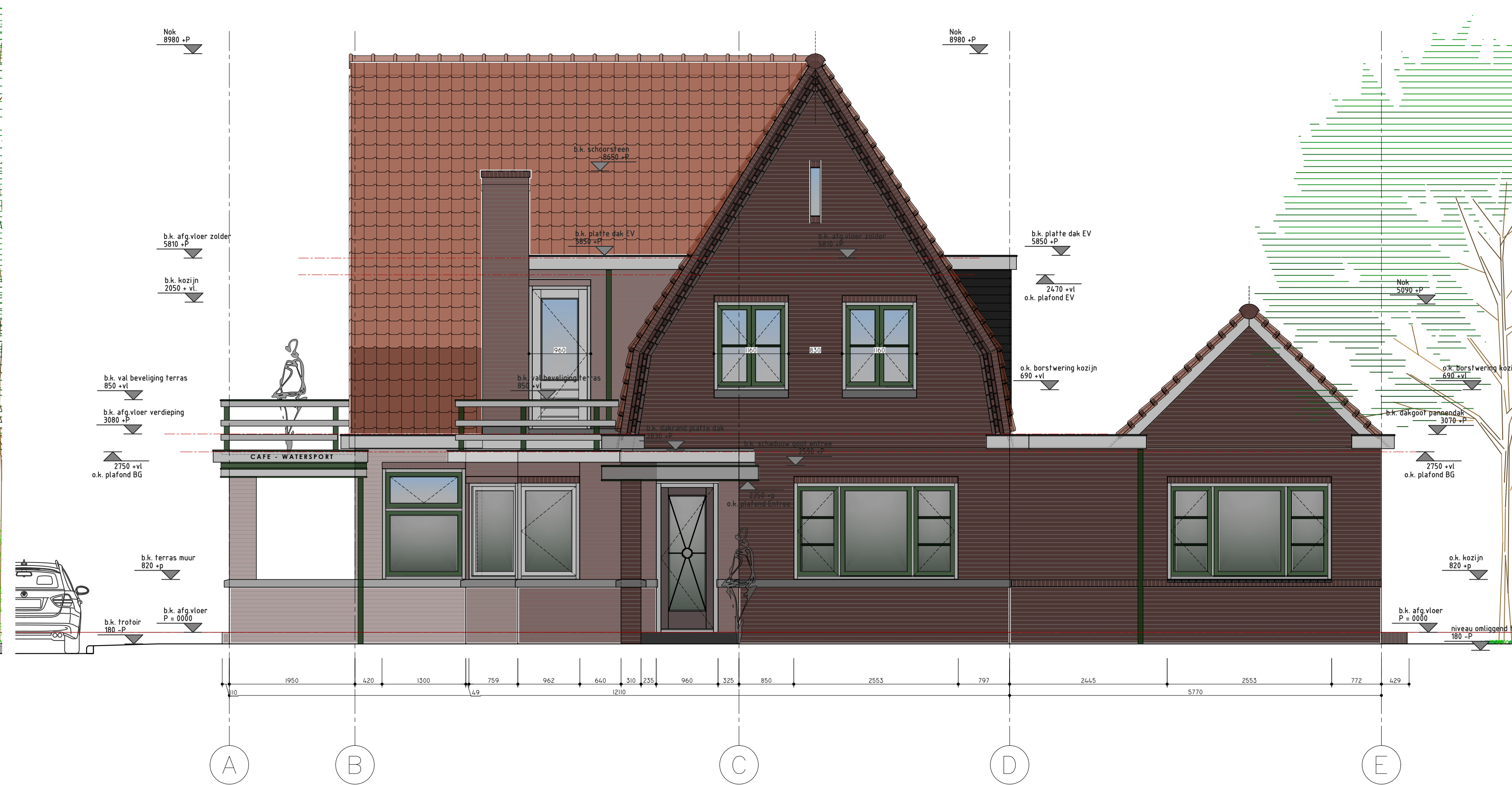
ZIJGEVEL (NOORD-OOST) BESTAANDE SITUATIE SCHAAL 1:50
