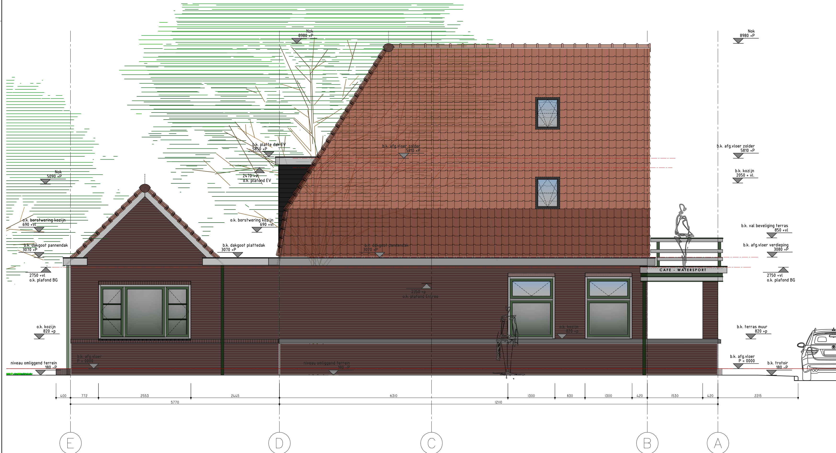
ZIJGEVEL (ZUID WEST) BESTAANDE SITUATIE SCHAAL 1:50
