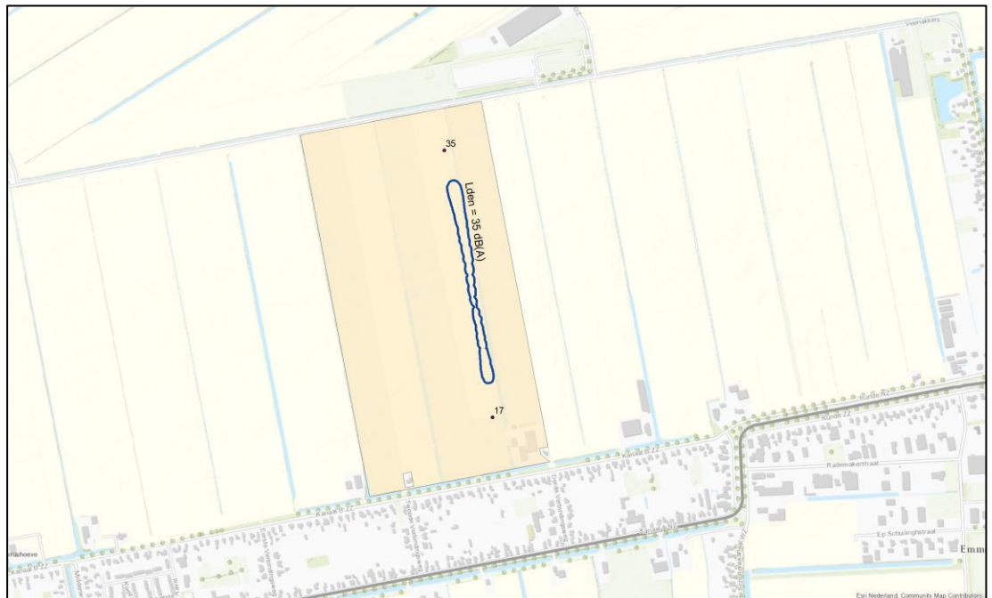
Figuur 4.1 Contour van L_{den} = 35 dB(A). Het oranje vlak is het terrein van de luchthaven.
