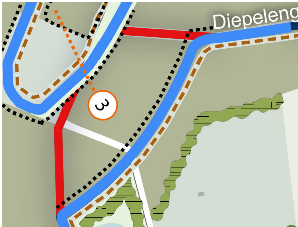
Figuur 14 bochtafsnijding Diepeleng (rood = gedempte oude loop)
