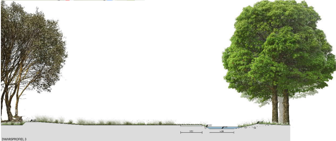
Figuur 9 Zuidelijke lus omgelegde Lollebeek, maaiveldverhoging langs bosrand voor zo min mogelijk landschappelijke verstoring open ruimte
