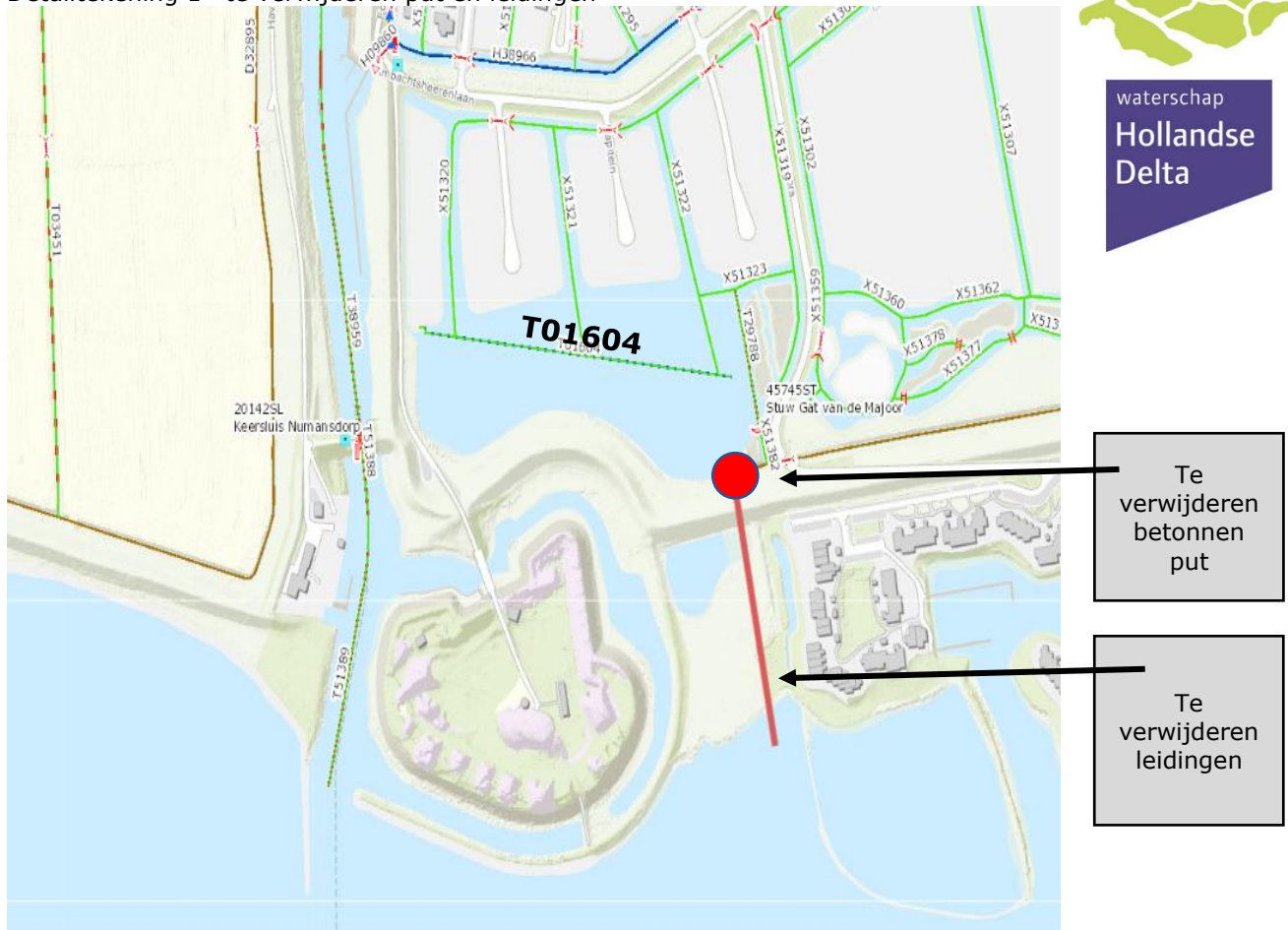
Detailtekening 1- te verwijderen put en leidingen
