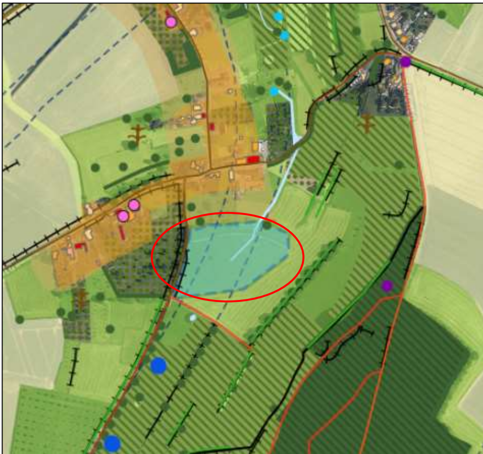
Figuur 6: Kernkwaliteiten groen karakter in het plangebied. Aangegeven zijn kernkwaliteit regenwaterbuffer (blauw oppervlak), watergang (blauwe waterloop), dalbodem (gestippelde lijnen) en één boom op de grens van het plangebied (Atlas Limburg).
