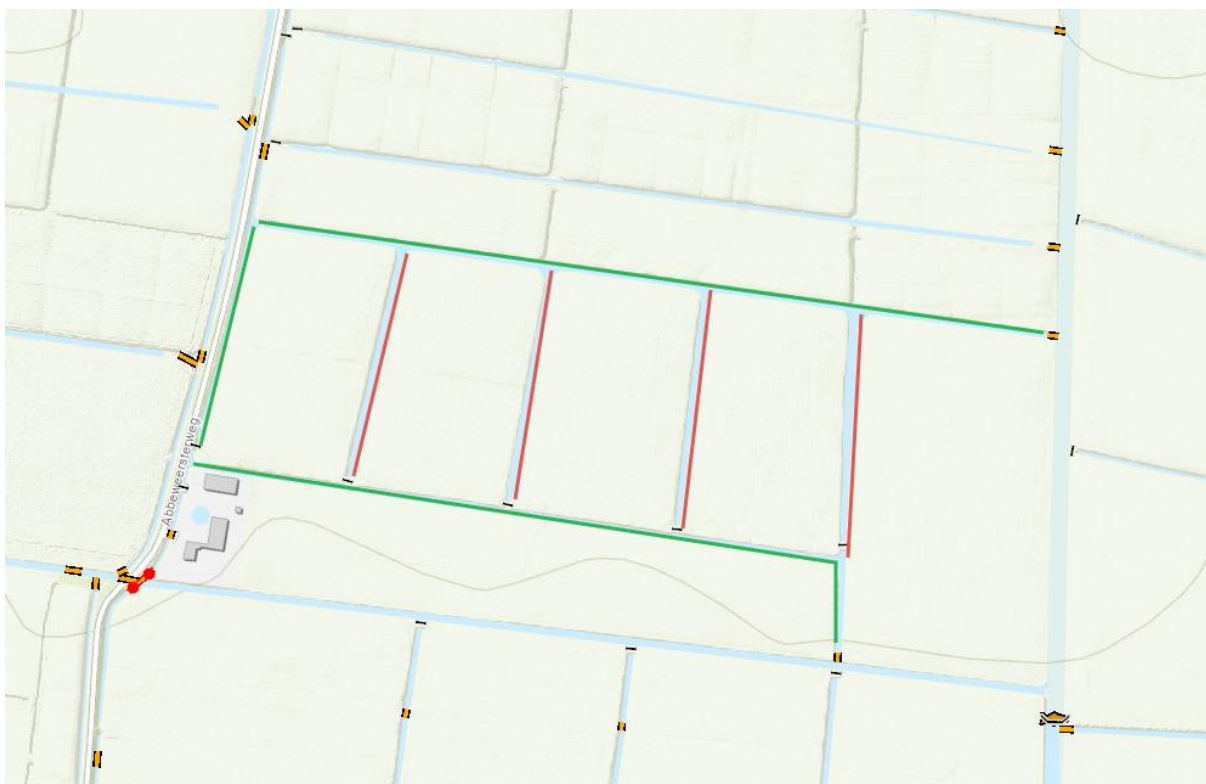
Figuur 1: Bovenstaand figuur geeft globaal het werkgebied weer. De rode lijnen geven de te dempen watergangen weer. De groene lijnen geven te verbreden watergangen weer.
