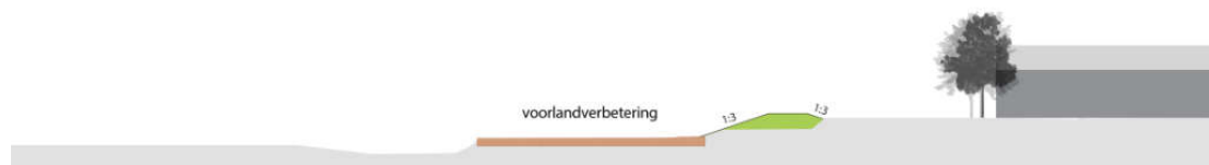
Figuur 26: Indicatief dwarsprofiel alternatief 5A
