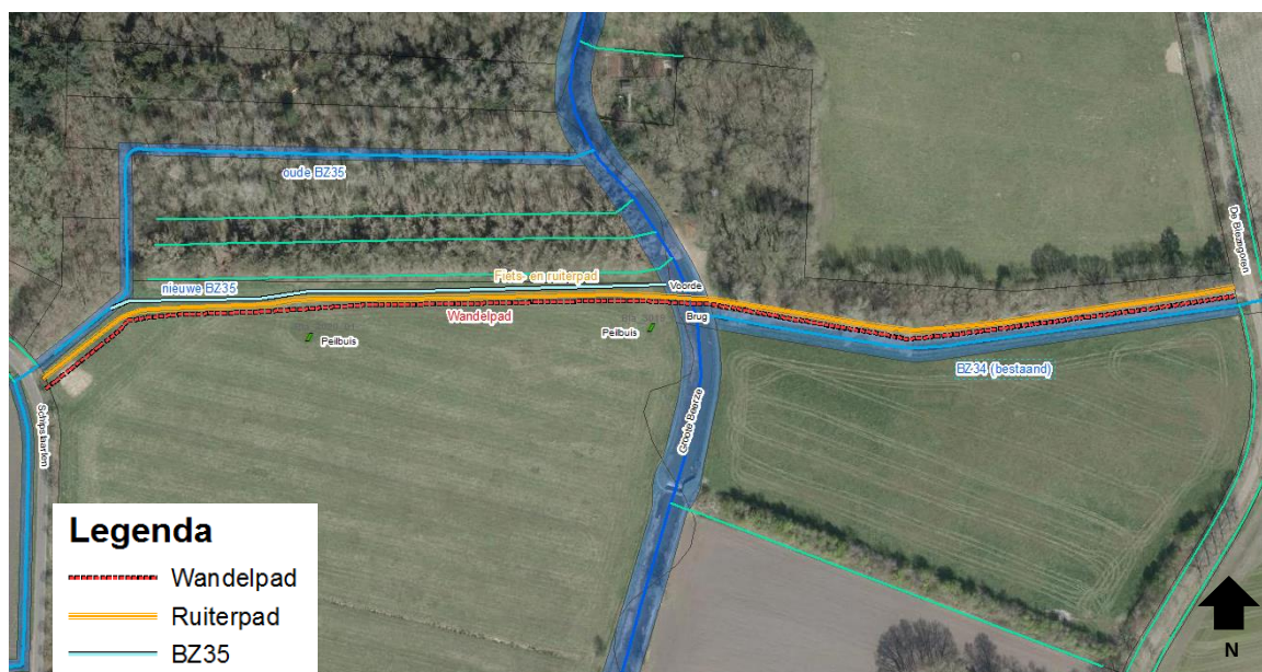
Fig. 5: Luchtfoto uitsnede verleggen watergang BZ35 en aanleg wandel- ruiterspad richting Groote Beerze
